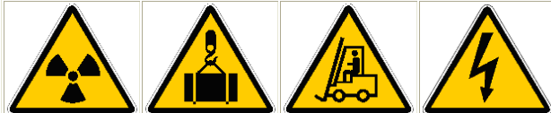
Materiali radioattivi/ Radioactive materials Carichi sospesi/ Hanging loads Carrelli di movimentazione/ Industrial vehicles Tensione elettrica pericolosa/ Dangerous electrical voltage
