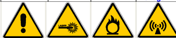
Pericolo generico/ General danger Raggi laser/ Laser Beams Materiale comburente/ Combustive material Radiazioni non ionizzanti/ non ionizing radiation
